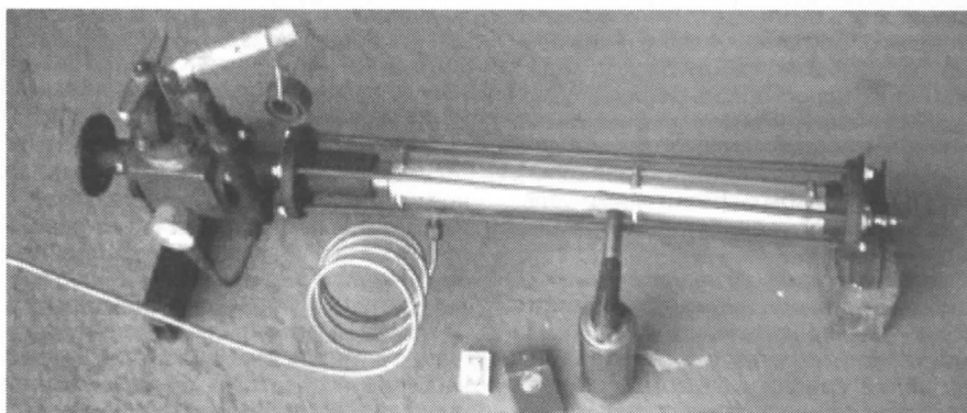
Опытная реакционная камера для термолитиза азотного топлива постоянного давления.
